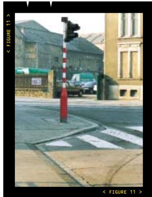
**Figure 11** ne pas placer le passage dans un virage
