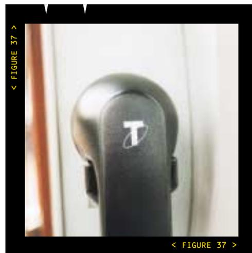
**Figure 37** combiné équipé d'un système d'induction pour porteurs d'appareils auditifs
